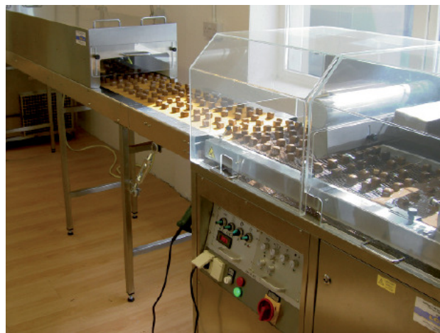
Große Flexibilität dank modularer Bauweise: links der LCM Kaskaden TWIN Temper mit Auflöser LCM 600 M mit Pumpe; rechts die Schokoladenüberzugsanlage LCM 320 ATC mit Kühl tunnel LCM 320 CTB im Einsatz.
