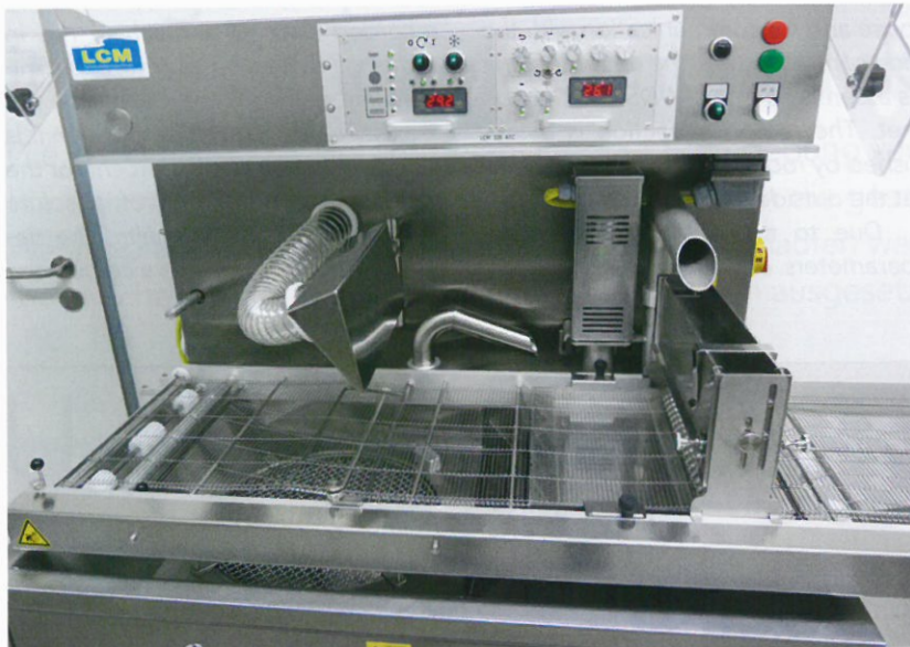
Die Überzugsmaschine LCM ATC-P 320 mit Zwischenpumpe. The enrobing machine LCM ATC-P 320 with booster pump.
