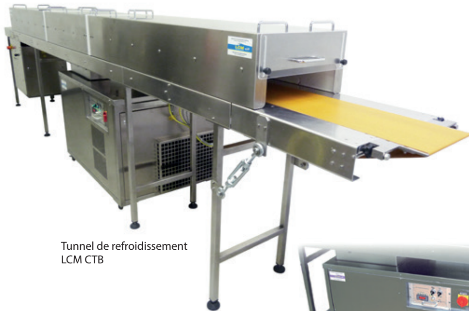
Commande de la bande LCM et groupe de réfrigération dans une unité séparée (version standard).
