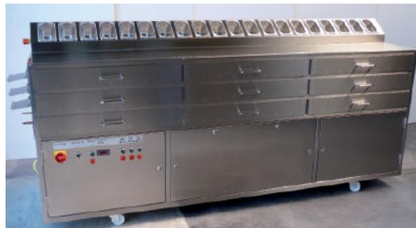
Innovationen für mittelständische Betriebe: Überzugsmaschine LCM 420 ATC mit Kühltunnel und der Bandkühler für die Schauproduktion.
